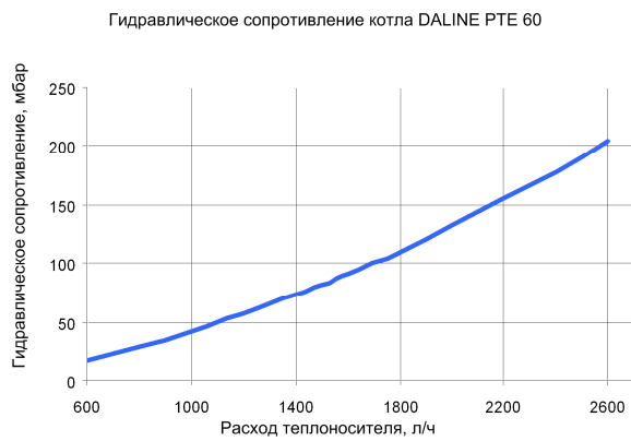
Рис.17. Гидравл. потери котла «Daline PTE 22-60»
